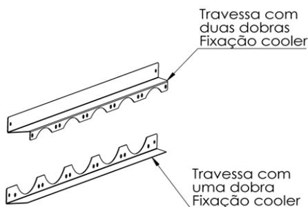
2° - Retirar parafusos que fixam a travessa de fixação das GPU's conforme imagem abaixo.
