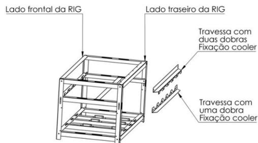
4° - Fixar as travessas do push and pull. Verifique-se que a travessa de fixação das GPU's, fica no mesmo lugar, e o sistema push and pull para o lado de fora da RIG conforme imagem abaixo.
